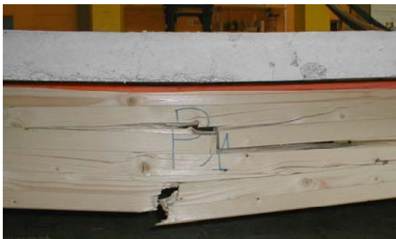
Figure 13 – Modes de rupture des planchers Sylvabat et Lignadal.
