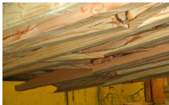
Figure 13 – Modes de rupture des planchers Sylvabat et Lignadal.
