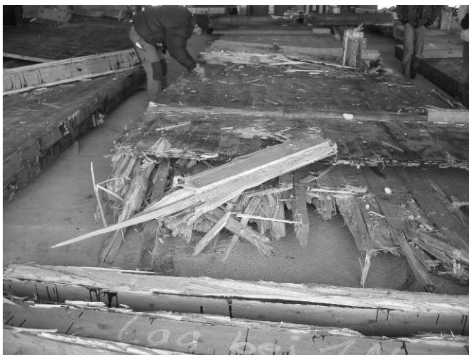
Abbildung 7: Generalkeilzinkenstoß einer Kämpfstegträgerplatte
