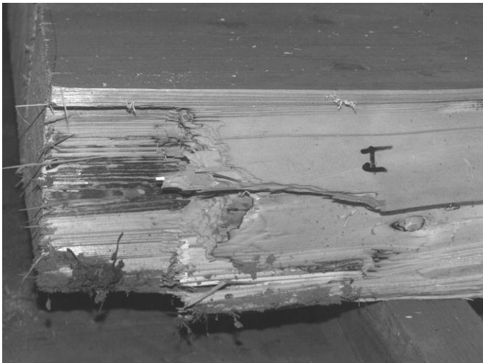
Abbildung 9: Beispiel für ringschälige Lamelle
