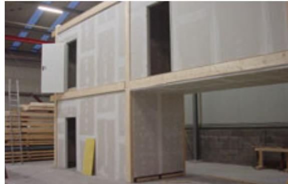
Abb. 8.3.3: Prototyp vor den Schallmessungen
