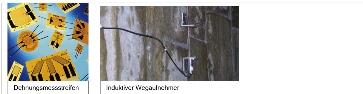
Abb. 12: Geräte zur automatischen Rissbreitenüberwachung (Beispiele; mit wenigen Erfahrungen an Holztragwerken) [HBM, LGA]
