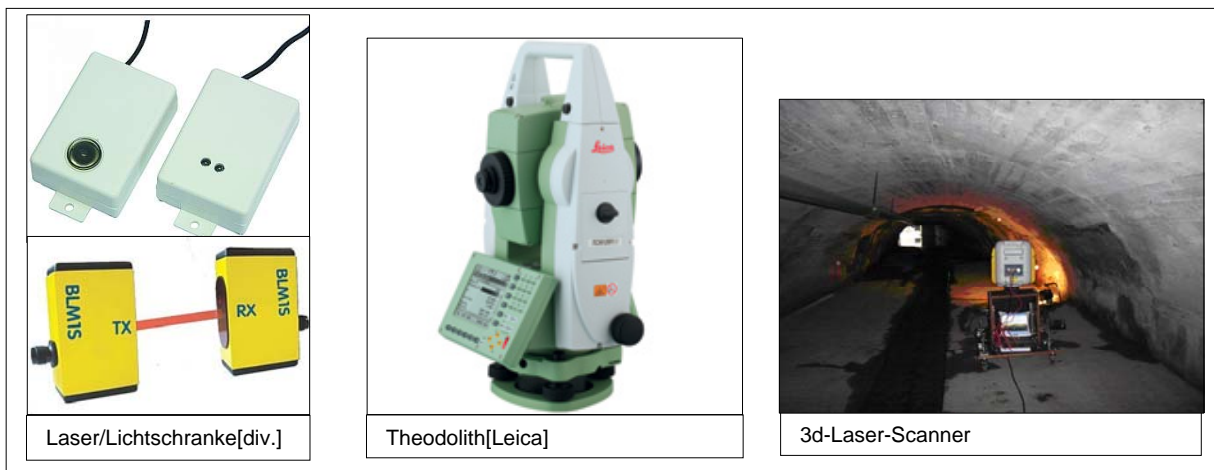
Abb. 11: Geräte zur automatischen Verformungsmessung (Beispiele, teils mit Erfahrungen an Holztragwerken) [Hersteller, LGA]
