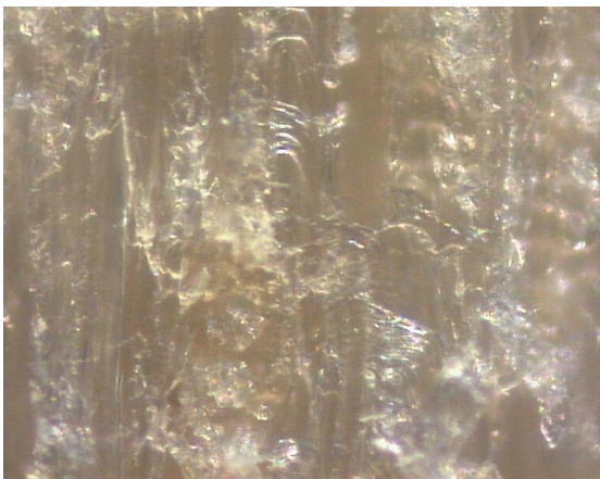
Bild 7: Mikroskopische Aufnahme von Kiefernholz, das 30 s in Luft plasmabehandelt wurde (0,4 mm 2 große Fläche bei 400facher Vergrößerung).
