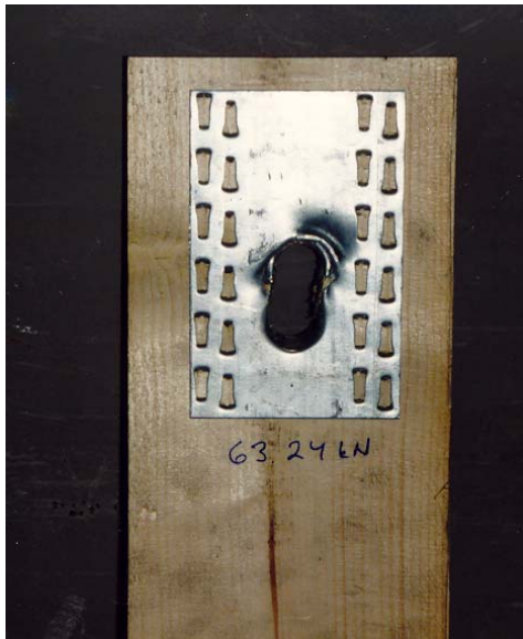
Abbildung 5: Mit Nagelplatte verstärkte Bolzenverbindung nach einer Belastung bis zum Versagen
