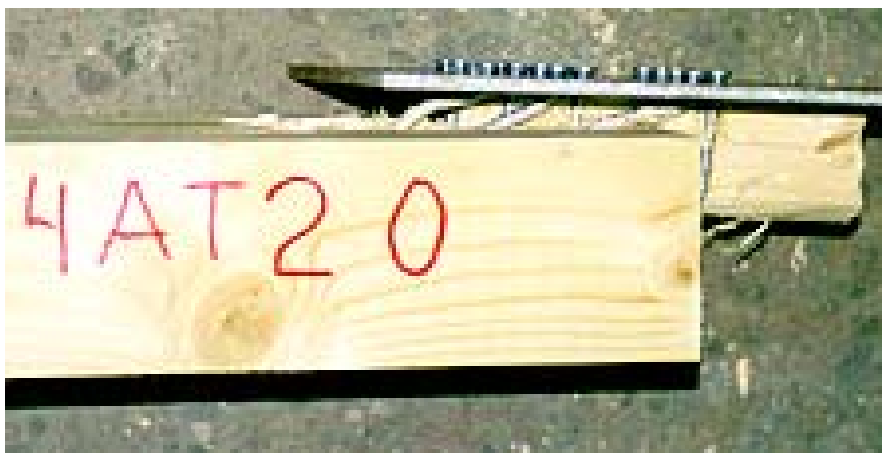
Abbildung 3: Blockscherbruch einer Testverbindung Quelle: J. Vesa
