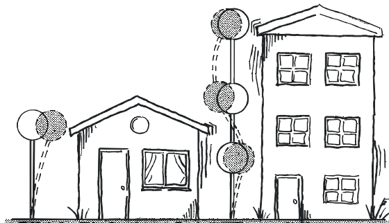
Bild 3. Einfaches Gebäudemodell zur Darstellung des dynamischen Verhaltens
