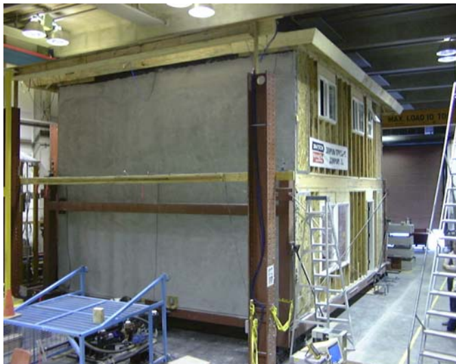
Bild 17: Zweistöckiges Haus auf dem Erdbebenprüfstand an der UBC in Vancouver
