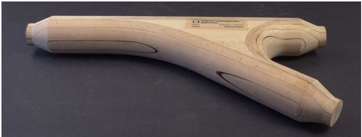
Abb. 6 Verkleinertes Modell eines Massiven Verbindungsstückes aus Buche und gestauchter Buche in der Sattelfläche; die Form wurde auf einer numerisch gesteuerten Werkzeugmaschine hergestellt.
