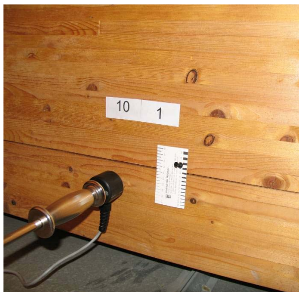
Abbildung 1: Beispiel für die Bezeichnung der Achsen und Bauteile (hier Hauptachse 10, Nebenachse 1)
