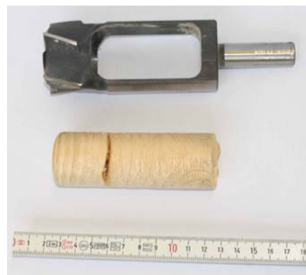
Abbildung 11: Holzprobe für die Überprüfung der Scherfestigkeit der Leimfuge nach EN 396
