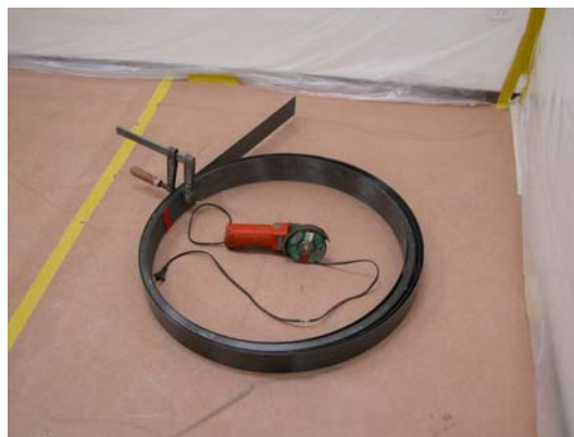
Bild 14: Die CFK-Lamellen lassen sich aufrollen und sind deshalb besonders gut geeignet für enge Raumverhältnisse.
