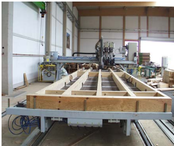
Abbildung 5: Fertigung der Deckentafeln mit CNC-gesteuerter Bearbeitungsbrücke der Otto Baukmeier Fertigung GmbH
