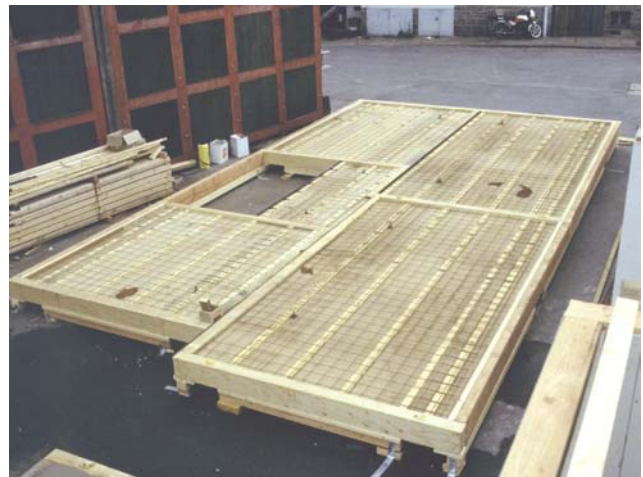
Abbildung 5: Fertigung der Deckentafeln mit CNC-gesteuerter Bearbeitungsbrücke der Otto Baukmeier Fertigung GmbH
