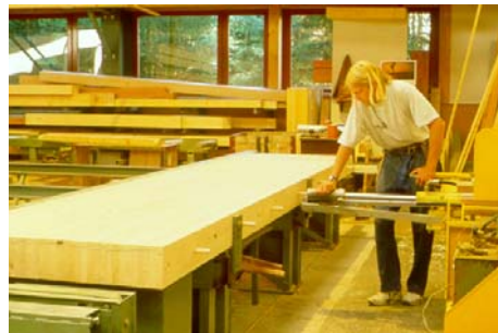
Bild 2: Bereits die erste Fertigung der gedübelten Brettstapelemente erfolgte halbautomatisch
