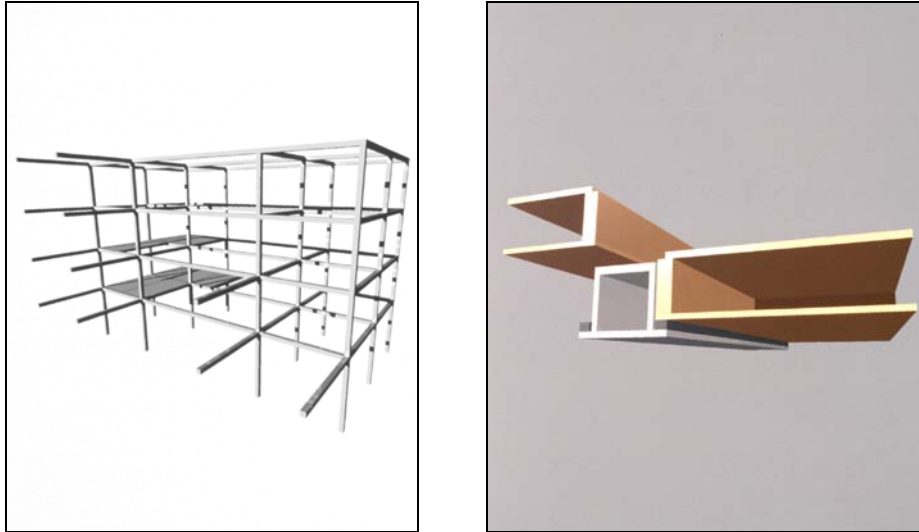
Abbildung 9: Tragendes Stahlskelett mit eingelegten Holz-Hohlkörperdecken
