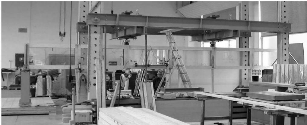
Abbildung 14: Holz-Glas-Träger (6-feldiger Schubfeldträger:  $H = 83,7\text{cm}$ ,  $L = 827,2\text{cm}$ ) im eingebauten Zustand
