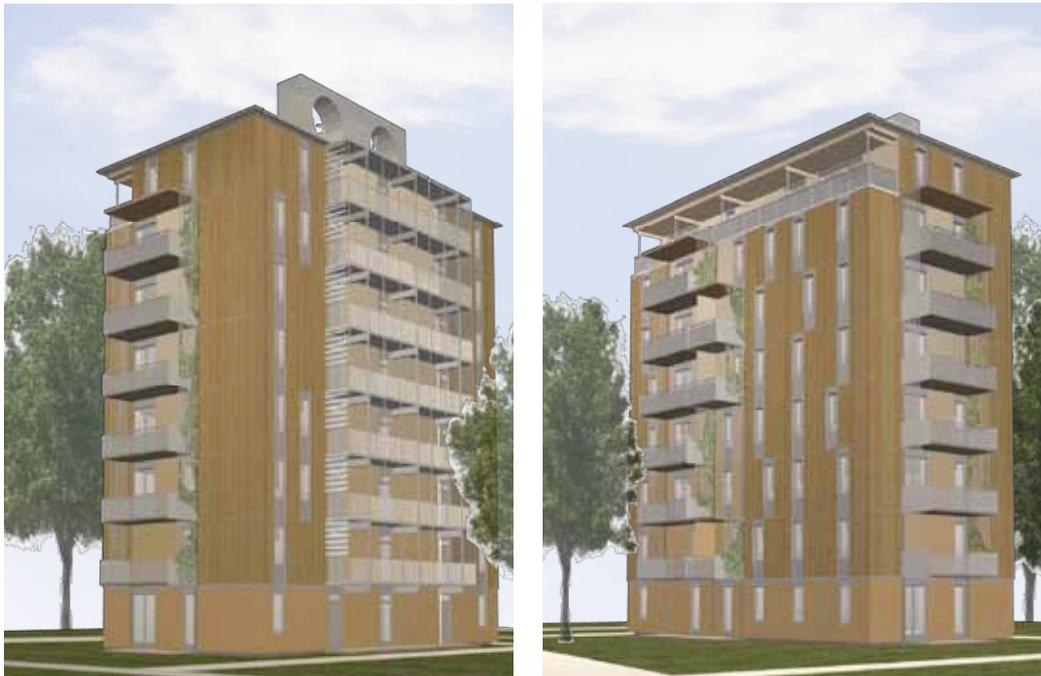
Die Holzschalung soll diesmal allerdings mit einer deckenden Dünnschichtlasur versehen um größere Wartungsintervalle zu bekommen.
