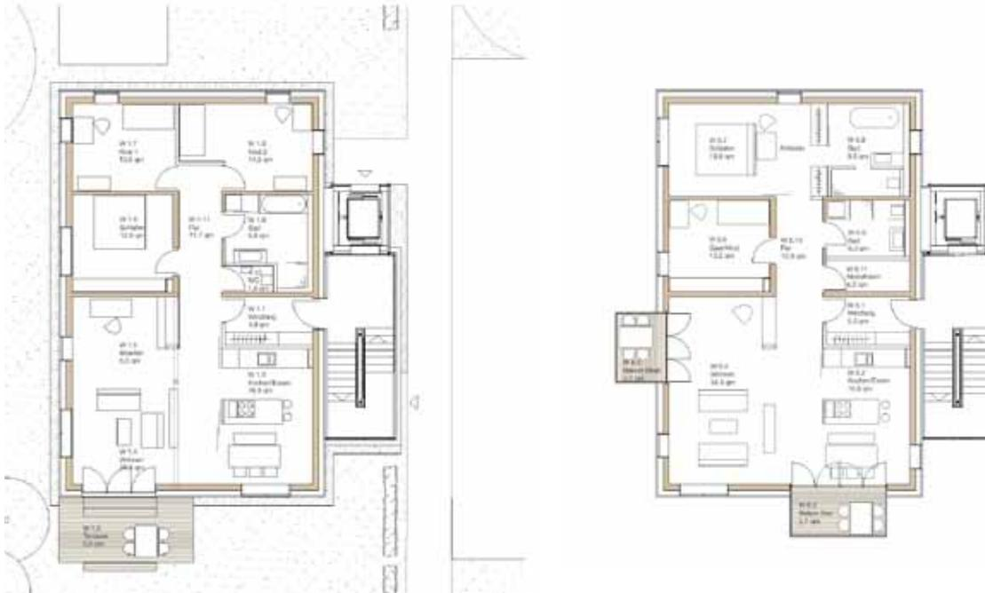
Es sind zwei verschiedene Grundrisse in verschiedenen Standards realisiert worden: links – das Erdgeschoß mit einer 4-Zimmer-Wohnung mit großer Terrasse, rechts – das 3. Obergeschoß mit einer 3-Zimmer-Wohnung mit zwei Loggien.
