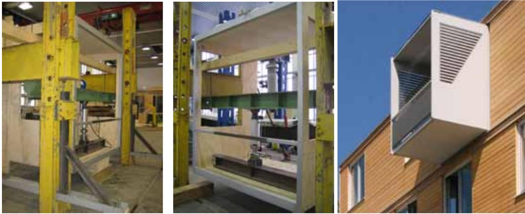
Bei den selbsttragenden Holz-Loggien musste allerdings eine gewisse Skepsis überwunden werden. Daher wurde ein Musterbalkon in der Prüfanstalt der TU München Belastungstests unterzogen. Die Tests haben gezeigt, dass alle Beteiligten – sowohl die Prüfanstalt, die ihre Versuchsanordnung zwischen durch verstärken musste, als auch das Planungsteam die Tragfähigkeit der Konstruktion unterschätzt haben.
