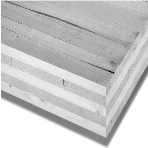
Abbildung 1: Brettsperrholz besteht aus mindestens drei kreuzweise verleimten Lagen (Quelle: proholz, Schmölzer)
