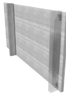
Abbildung 14: Anschluss von Flächenelementen
