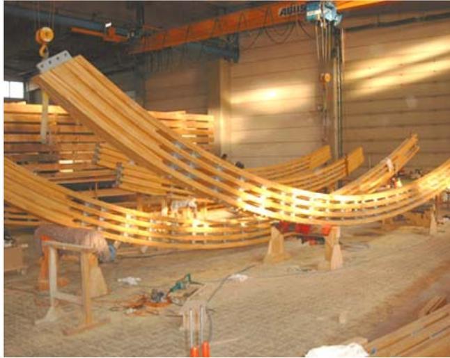
Abbildung 11: fertiggestellte Bindersegmente
