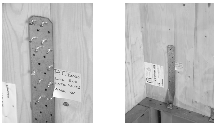
Figura 9: Crisi degli holdown dopo il terremoto di Nocera Umbra a 1,2g di PGA [5].
