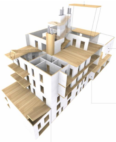
Links: Beim neuen Leuchtturmprojekt in der Via Cenni in Mailand sind Wände und Decken aus BSP-Platten. Sie bilden eine Wabenstruktur mit hoher Steifigkeit. Rechts: Balkone und Loggien lockern die Fassaden auf und schaffen ein modernes Flair. (Bildquelle: Architetti Associati Rossi Prodi, Florenz)
