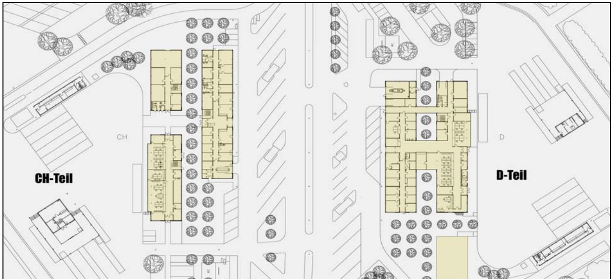
Abbildung 3: Zentraler Bereich mit Reisendenabfertigung mittig und Warenabfertigung D-Teil (Einreise nach Deutschland) und CH-Teil (Einreise in die Schweiz)
