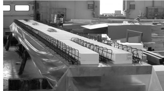
Abbildung 21 und 22: HBV-Hohlkastenträger
