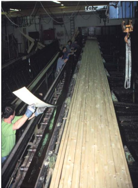
Abb. 6: Einlegen der Aramid Lamelle
