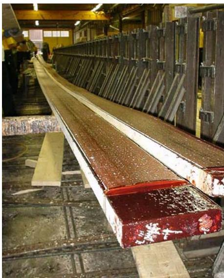
Abb. 7: Resorcinharzbeleimte Aramid Lamelle
