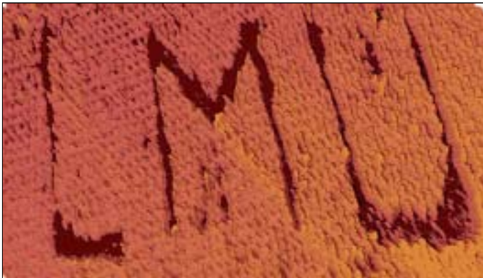
Abb. 2: Rastertunnelmikroskopische Abbildung eines nanomechanisch durch Einzelmolekülablation erzeugten Logos der LMU München mit ca. 2 nm Schriftbreite
