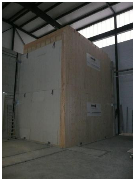
Abbildung 2: Die stirnseitigen Defaultelemente sind gegen zwei Prüfwände ausgetauscht worden
