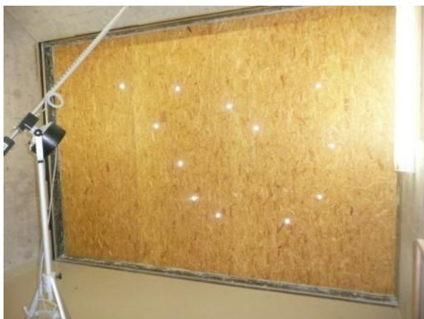
Abbildung 6: Grundwand im Wand- bzw. Direktschallprüfstand, Fläche 12,2 m 2
