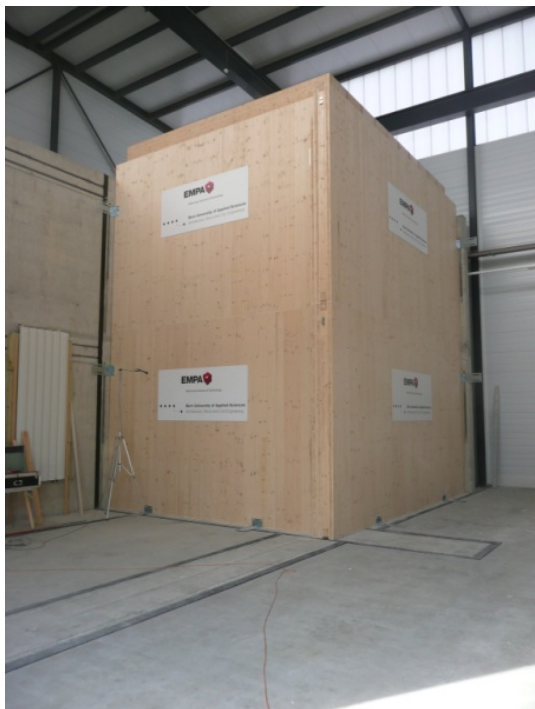
Abbildung 1: Prüfstand mit Defaultelementen zur Einmessung, zwei Räume übereinander angeordnet
