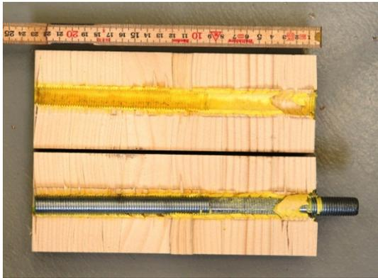
Abbildung 5: Adhäsionsbruch Klebstoff – Stahl
