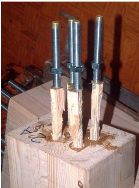
Abbildung 8: Ausreißen des Stabs inklusive eines Teils des umgebenden Holzes
