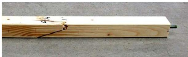
Abbildung 9: Zugbruch des Holzes
