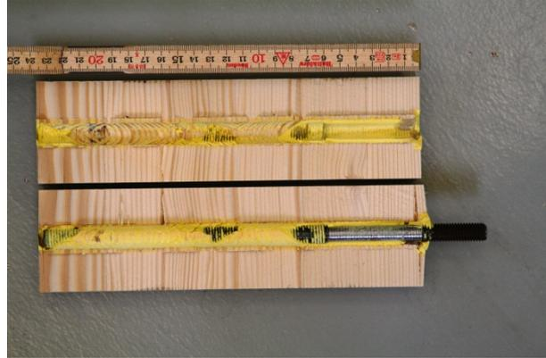
Abbildung 4: Adhäsionsbruch Klebstoff – Holz
