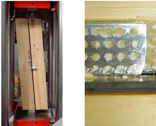
Abbildung 3, 4, 5: Versuchsaufbau. Detail Lochblech nach dem Versuch mit deutlicher Verformung der unteren Lochreihe zu Ovalen. Last-Verschiebungs-Diagramm.
