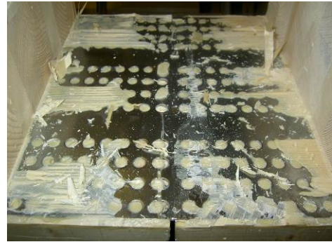
Abbildung 45, 46: Kraft-Verformungs-Diagramm für einen Prüfkörper mit ausgeprägt plastischem Fließverhalten und anschließendem Versagen des eingeklebten Lochblechs. Detaildarstellung eines im Rahmen eines Zugwellenversuchs getesteten Prüfkörpers mit einem Ermüdungsversagen des Lochblechs.
