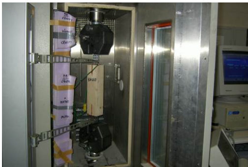
Abbildung 1, 2: Zugversuch zur Ermittlung der Temperaturbeständigkeit von in Holz eingeklebten Lochblechen. Temperatur-Verformungs-Diagramm für in Holz eingeklebte Lochbleche.
