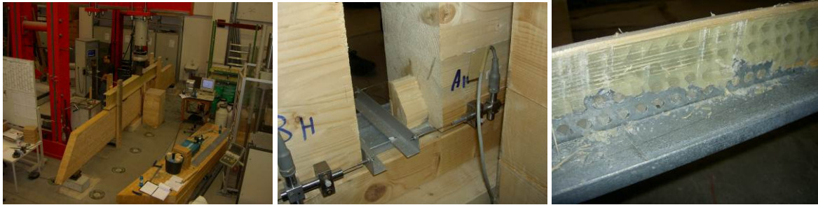
Abbildung 38, 39, 40: Versuchsaufbau. Abscheren des Holzes im Bereich der Klebeverbindung. Detailaufnahme des Lochbleches mit einer deutlichen Verformung der ursprünglich runden Lochungen zu Ovalen im Bereich der ersten Lochreihe.
