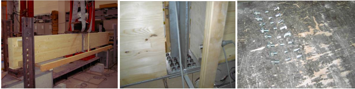
Abbildung 35, 36, 37: Versuchsaufbau. Kopplung der beiden Stahlflansche mit dem mittigen Stahlprofil über Schraubenverbindungen. Abscheren der Schrauben als Versagensursache.
