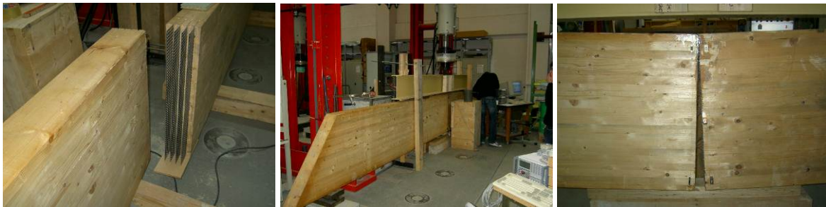
Abbildung 41, 42, 43: Prüfkörper mit 4 Lochblechen in der Kontaktzone während der Herstellung. Versuchsaufbau als 4-Punkt-Biegeversuch. Versagen der Lochbleche als globales Prüfkörperversagen.
