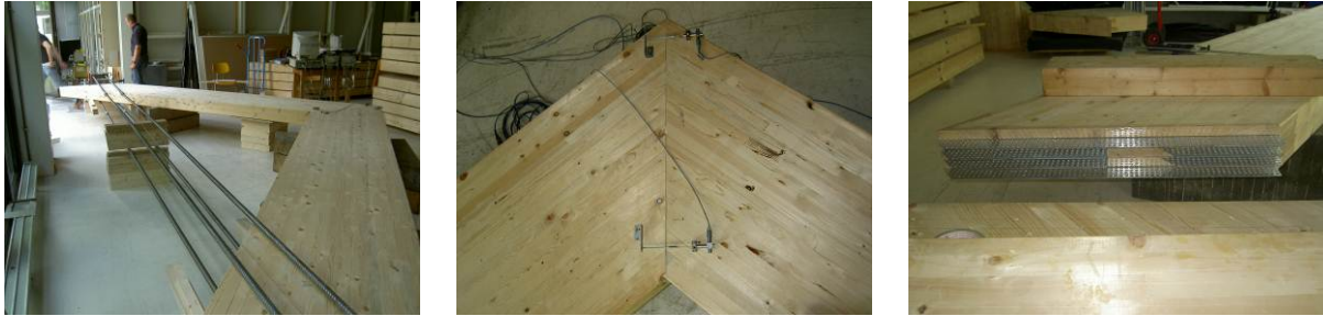
Abbildung 19, 20, 21: Versuchsaufbau. Applizierte Messtechnik. Eingeklebte Lochbleche bei PK IV-12.
