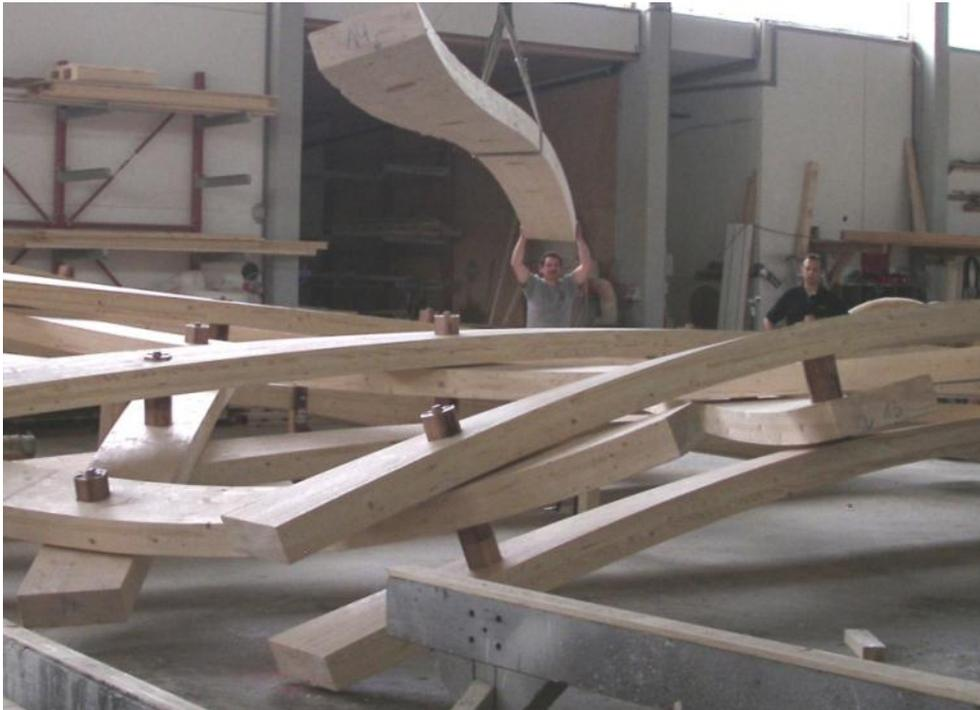
Abbildung 10: Musterelement 1/1 für Angebot ©Holzbau Amann GmbH
