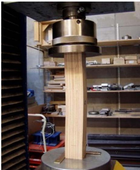
Abbildung 25: Druckversuch Sperrholz
