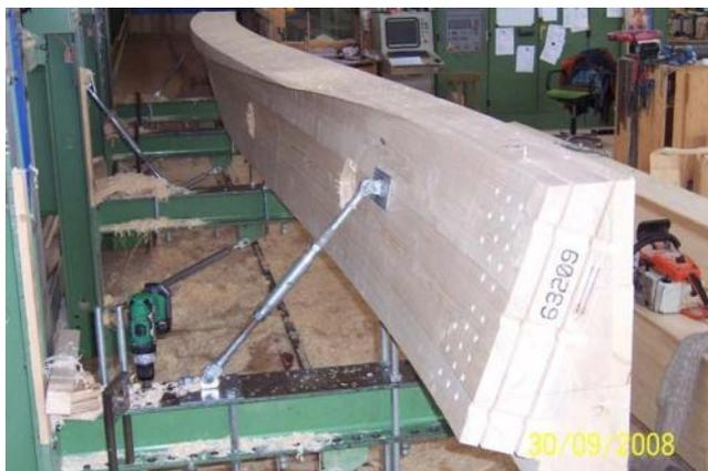
Abbildung 34: Gurt zur Hälfte gefräst ©Holzbau Amann GmbH
