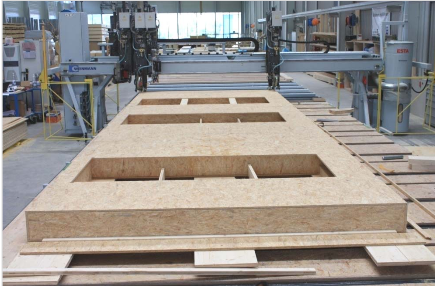
(Bild 18), Befestigen der äusseren Beplankung
