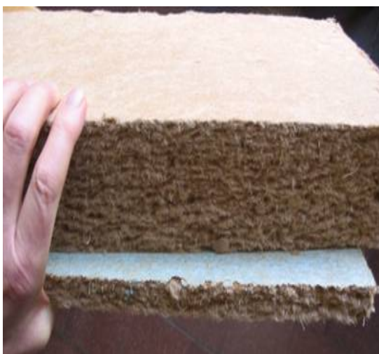
Abb. 9 a – b: Pavadentro Innendämmplatten mit Funktionsschicht für den Kapillartransport. Fotos: Wilfried Walther und Robert Borsch-Laaks
