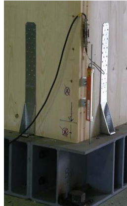
Abb. 9: Abheben der Zuganker
