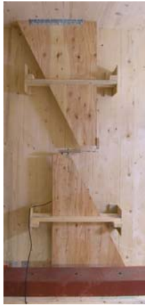
Abb. 8: Relativverschiebung der Geschosse
