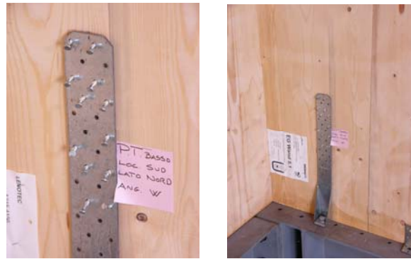
Abb. 12: Zugankerversagen nach Nocera Umbra 1,20g
