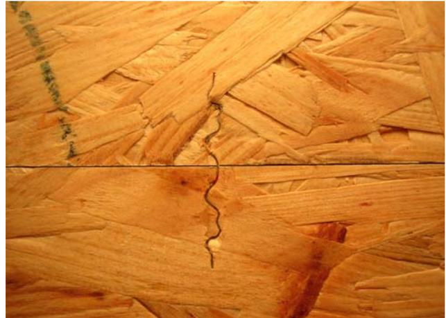
Abbildung 19: Freier Stoss mit JUMBO®-Wellennägeln
