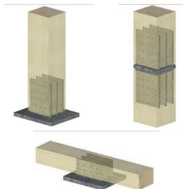
Figur 4: Perspektive der Tragwand TWX1, der Verankerungspunkte in die Fundation, die Stockwerksübergänge und detailliert die gewählte Konzeption der Tragwände in Tragrichtung x und y.
