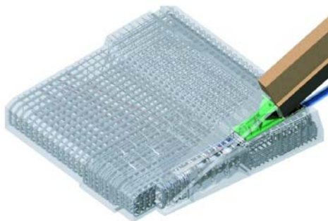
wehrung Endquerträger Visualisierung Bollinger+Grohmann
