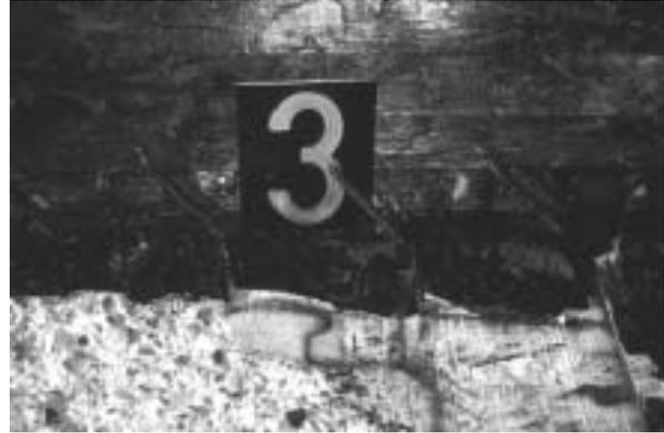
**Abb. 21** - Äussere SFS Schrauben beim BSH-Balken Nr. 3 der Holz-Beton-Verbunddecke mit SFS Schrauben vollständig freigebrannt. Versagen der Verbundfuge zwischen Beton und Holz nach 67 Min.
