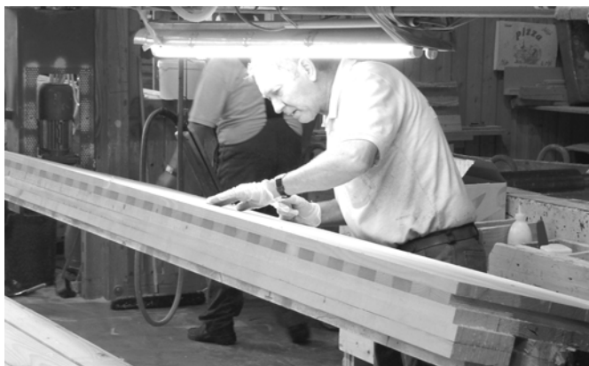
Tragendes Element mit fertiger Oberfläche: Qualitätskontrolle in der Produktion
