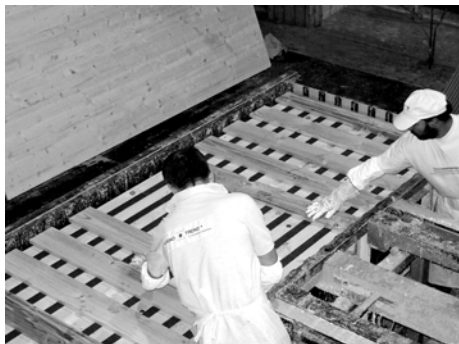
Kreuzweises Verleimen von Brettlagen bei der Brettsperrholzproduktion
