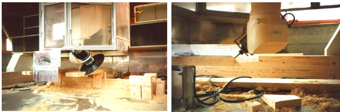
Abbildung 10 : CNC Anlage a) Säge b) Bohrung
