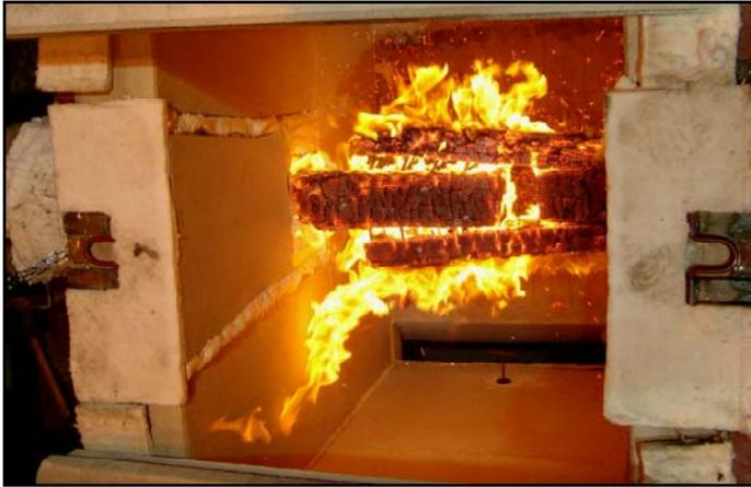
Abbildung 6: Draufsicht auf den Brandofen nach Abschluss des Versuchs an einer zweischnittigen Holz-Holz-Stabübelverbindung
