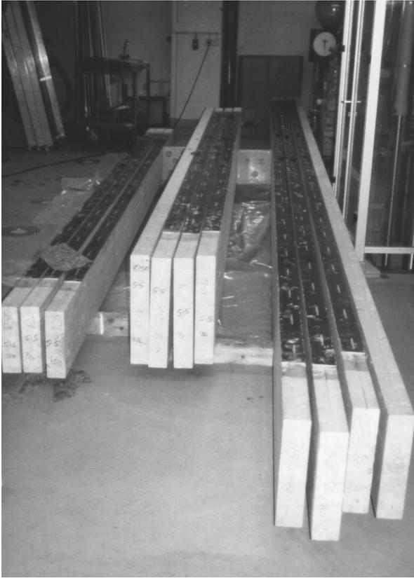
Das eingesetzte CFK Hybrid in der Lamelle kann durch einen neu entwickelten Herstellungsprozeß entscheidend kostengünstig hergestellt werden. Zudem lässt sich die Zugfestigkeit und E-Modul der Lamelle variieren.
