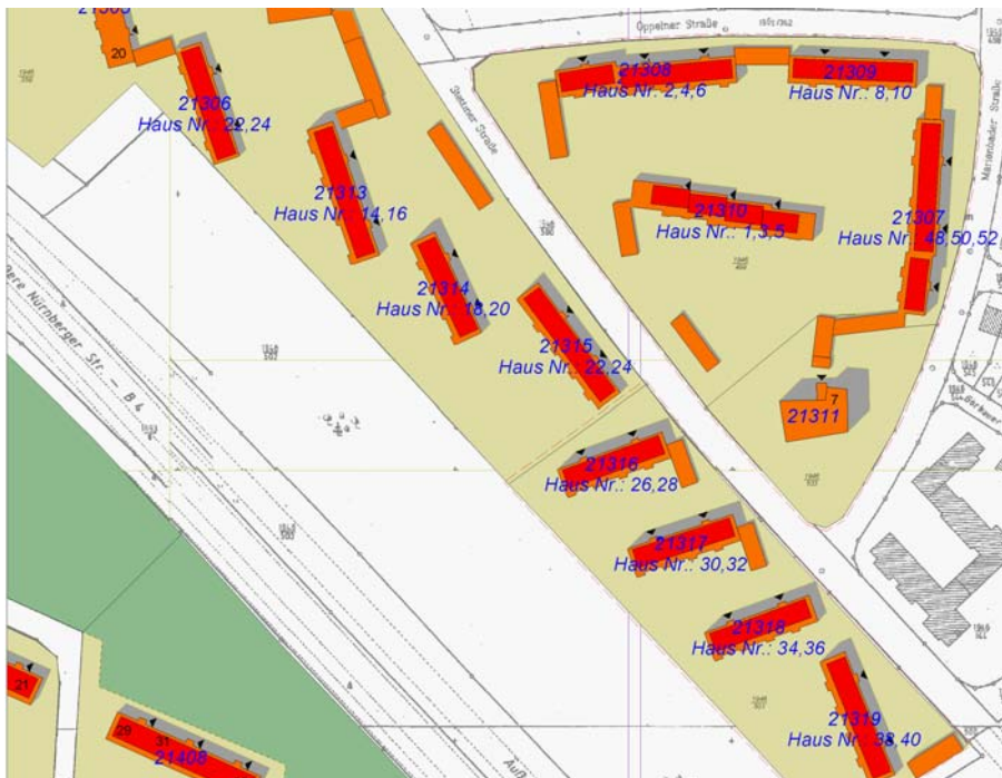
Abbildung 2: Neubau von 30 Wohnungen durch Aufstockung der vorhandenen Gebäude
