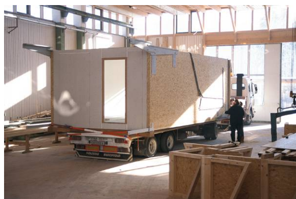
Abbildung 5: Herstellung der Module, Hotel Post
