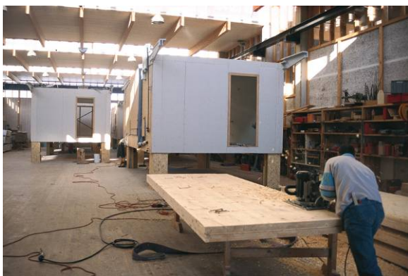
Abbildung 4: Herstellung der Module, Hotel Post
