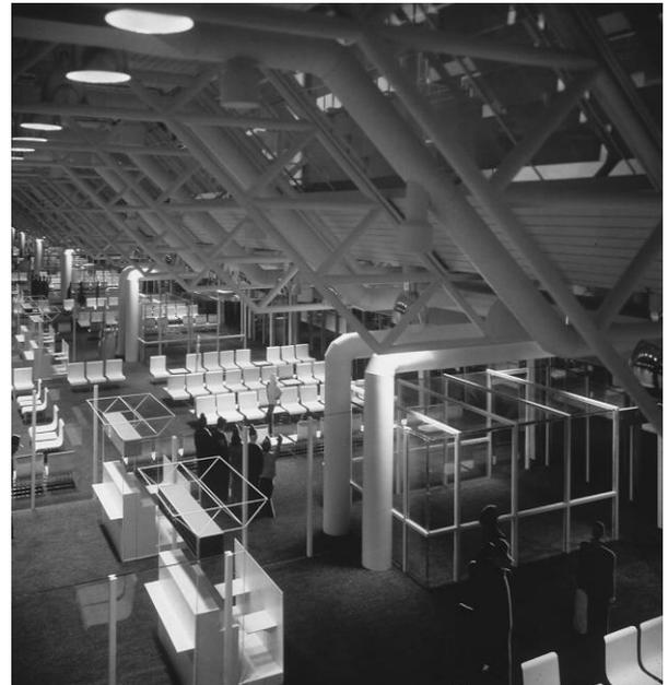
Bei beiden Bildern herrscht eine Beleuchtungsstärke von  $300 \text{ lx}$  vor. Das linke Bild zeigt einen dunklen Raumeindruck da die Bestuhlung in der Wartehalle des Flughafens einen geringen Reflexionsgrad (dunkelblau) aufweist. Das rechte Bild hingegen unterscheidet sich lediglich durch den Reflexionsgrad der Stühle (weiße Stühle). Dadurch kann bei gleichem Energieaufwand (Energie für  $300 \text{ lx}$ ) ein wesentlich größerer Helligkeitseindruck erzeugt werden.
