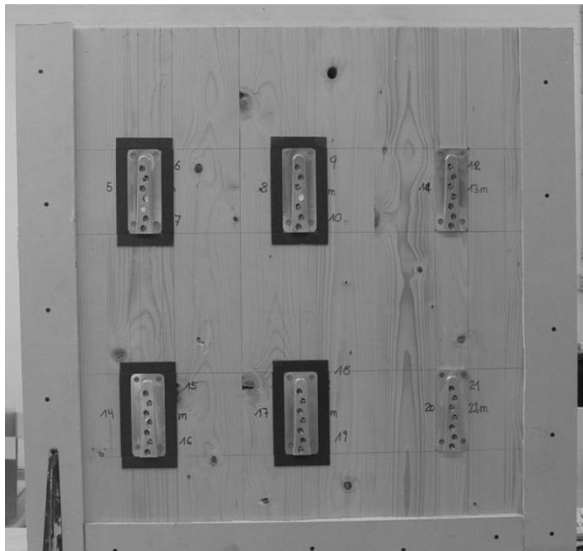
Abbildung 9: Prüfkörper mit Sensorik und teils LSK
