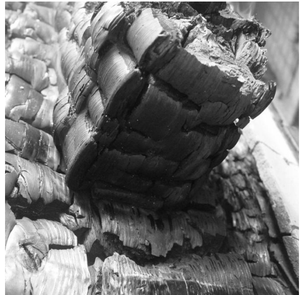
Abbildung 18: Variante C Ansicht Stoppel nach Abbrand
