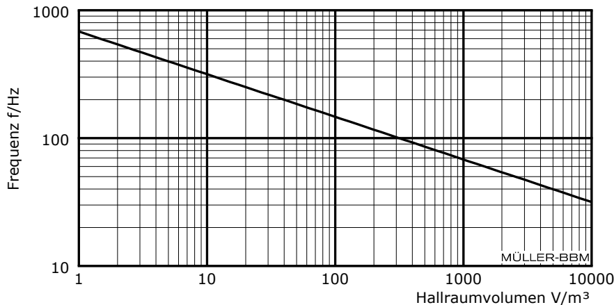
Abbildung 1: Untere Frequenzgrenze in Abhängigkeit vom Raumvolumen eines Hallraums gemäß Gleichung (1)
