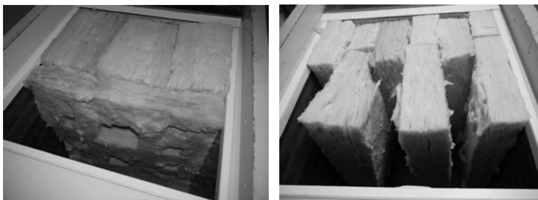
Abbildung 3: Messaufbau im Impedanzrohr mit einem quadratischen Querschnitt von 600 mm x 600 mm: Links: 420 mm dicker Flachabsorber, rechts: 420 mm dicker Keilabsorbers
