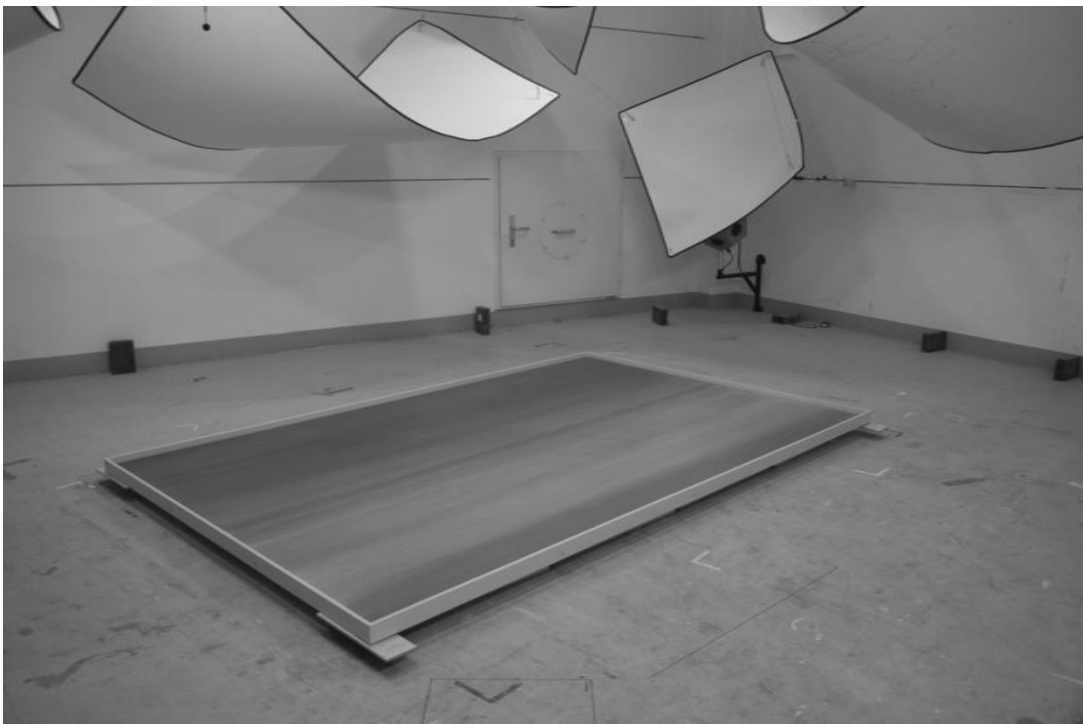
Abbildung 11: Messaufbau: Ölgemälde mit 90 mm dicker Dämmmaterialeinlage und einer Gesamtaufbauhöhe von 95 mm; Länge x Breite = 3050 mm x 1950 mm
