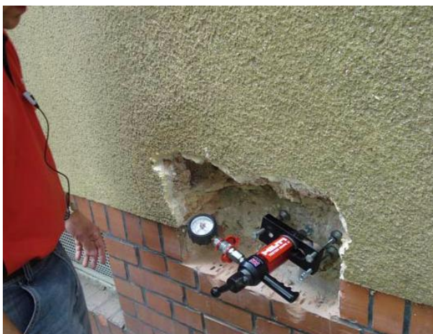
Bild 1: Versuchseinrichtung für Dübelzugversuch in der Stirnseite der Stahlbetondecke
