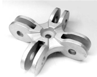
Für Gurt- und Diagonalstäbe werden jeweils separate Knotenformteile verwendet. Dies ermöglicht einen spannungslosen Zusammenbau, da weder innerhalb der Gurtstablage, noch bei den Raumdiagonalen statisch überbestimmte Systeme ( Dreiecke ) während der Montage entstehen. Erst am Schluß der Montage werden die Knotenformteile mittels Verbindungsschrauben zusammengezogen bzw. fixiert.
