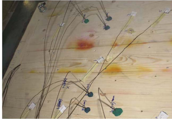
Abbildung 16: Kaltseite nach Versuche Quelle : EMPA Dübendorf
