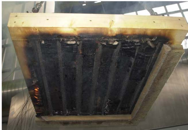
Abbildung 17: Ofenseite nach Versuche Quelle : EMPA Dübendorf
