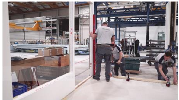
Abbildung 7: Fertigung der Raummodule in der Werkhalle der Renggli AG in Schötz.
