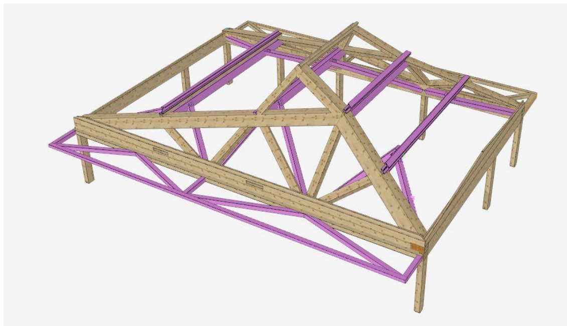
Abbildung 4: Sprengwerk mit horizontalen Fachwerken
