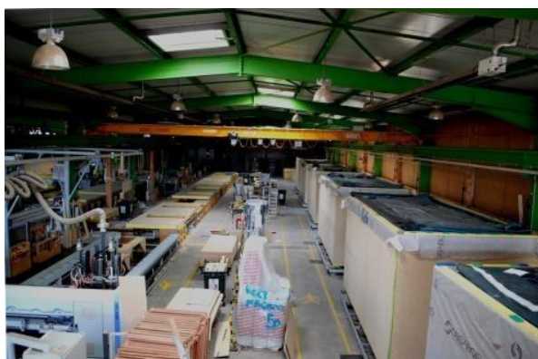
Une des 3 lignes d'assemblage 3D d'OSSABOIS
